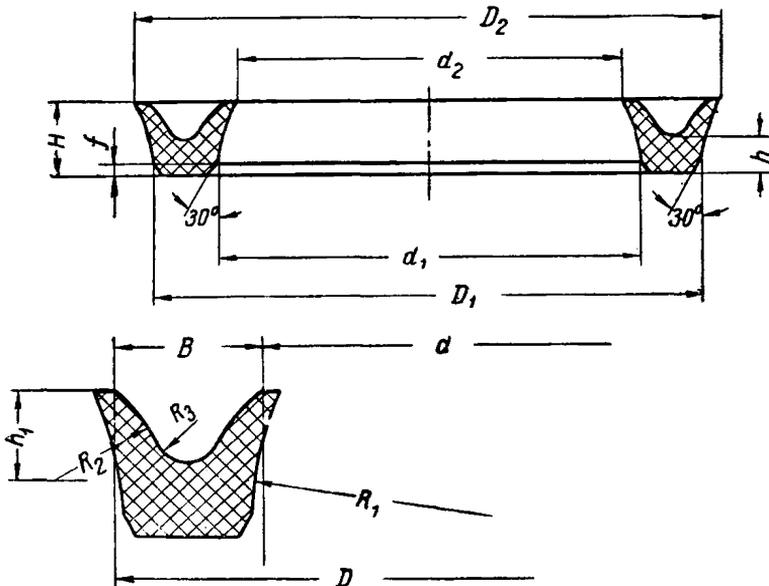
Примечание.  $D$  и  $d$  — уплотняемые диаметры.
